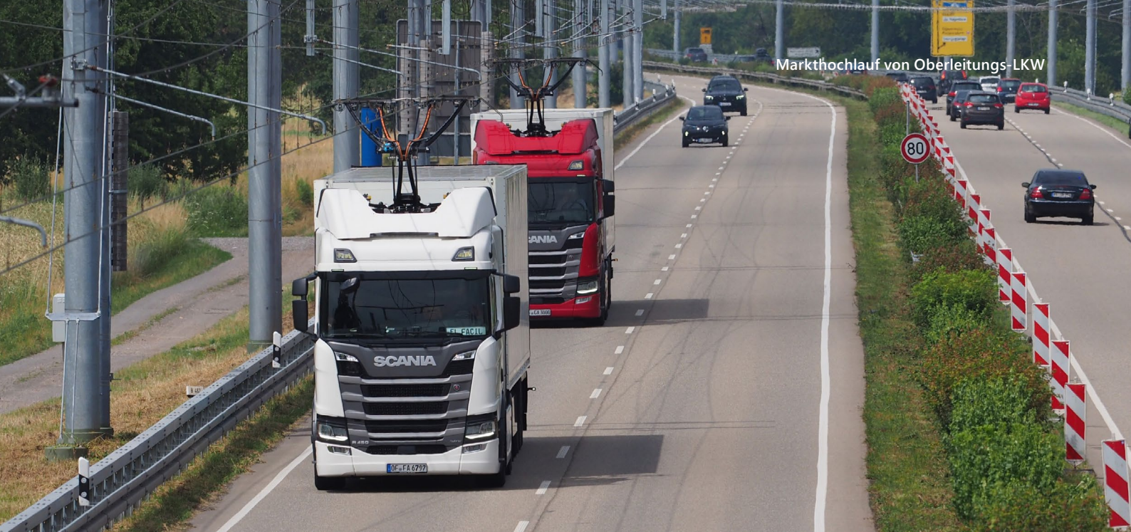
Abbildung 2: Oberleitungs-Hybrid-Lkw auf der Pilotstrecke eWayBW, Quelle: Ministerium für Verkehr Baden-Württemberg
