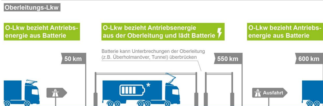
Abbildung 8: Prinzip des Oberleitungs-Lkw
