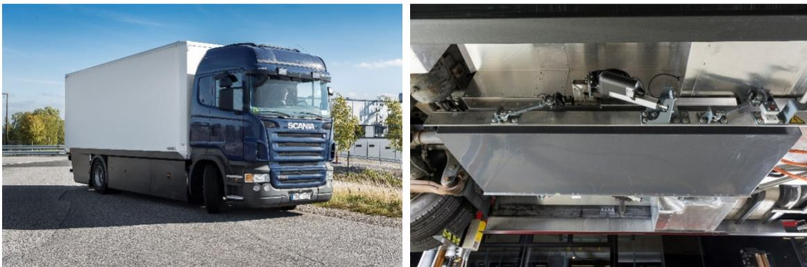
Abbildung 23: Scania-Lkw mit Induktionstechnologie (Scania 2016)
