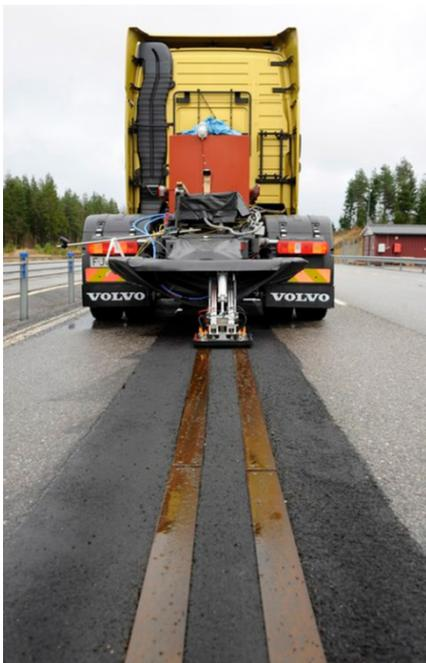
Abbildung 10: Prinzip der induktiven Ladung mittels Stromschienen (Bildquelle: <http://news.volvogroup.com>)
