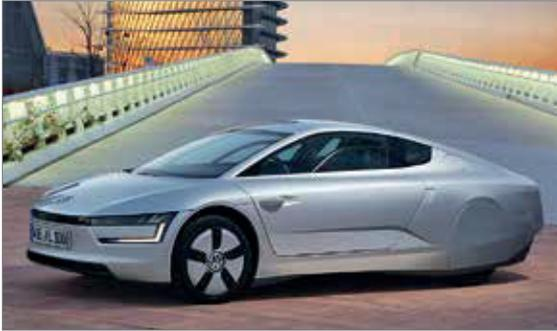
**Abb. 4.116: Volkswagen XL1 mit CFK-Monocoque**
