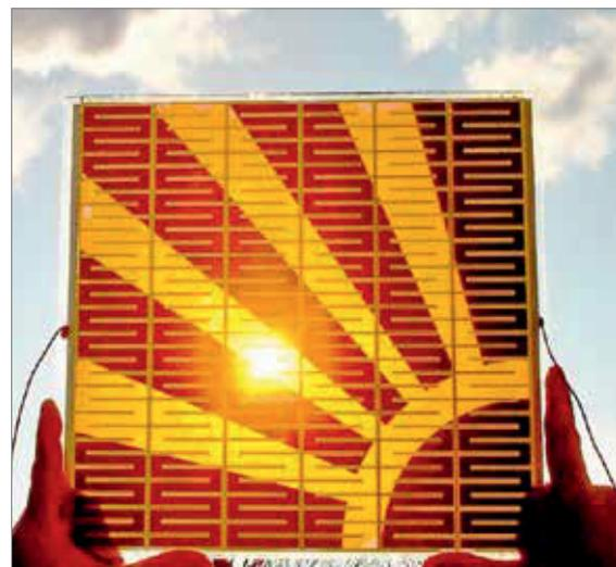
Abb. 4.46 Prototyp einer Farbstoffsolarzellen (Quelle: Fraunhofer ISE)
