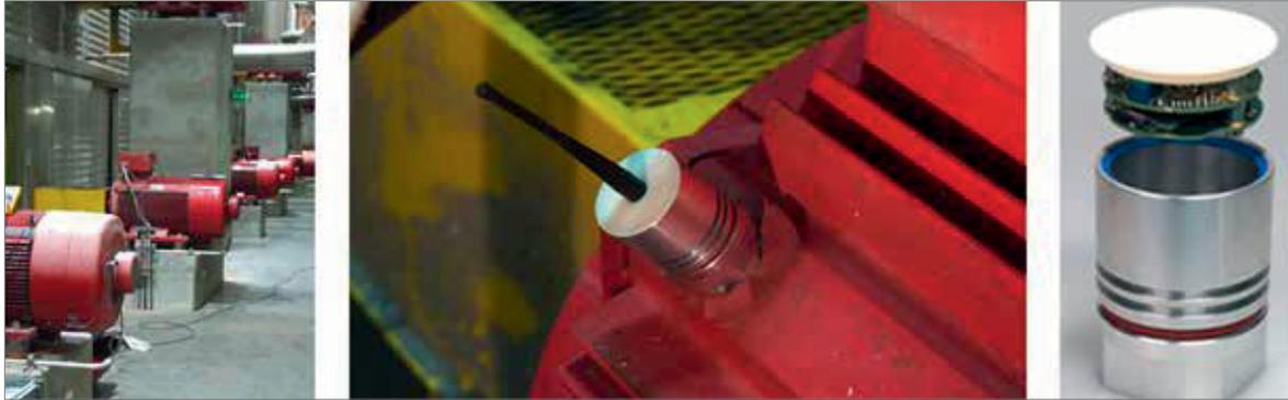
**Abb. 4.77: Thermoelektrisch betriebenes Condition Monitoring System in der Anwendungsumgebung Papierfabrik (Quelle: NIEDERMAYER et al. 2014)**
