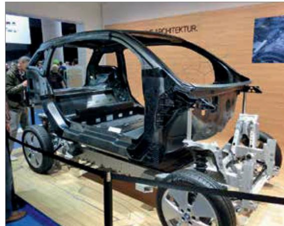
**Abb. 4.114:** Monocoque (Fahrgastzelle) des BMW i3 aus CFK auf Aluminium Fahrgestell (Quelle: Alexauto321, WIKIMEDIA)
